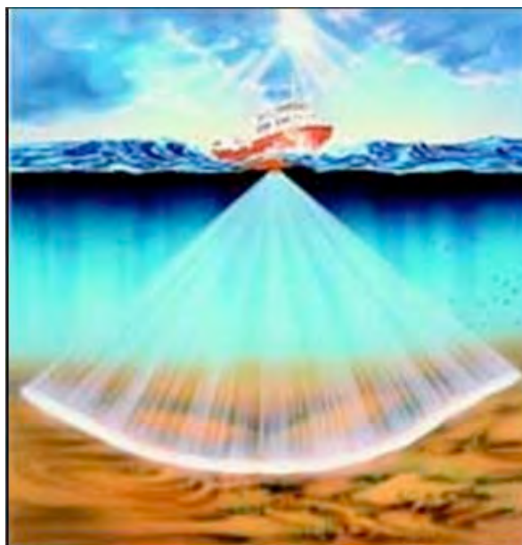
Figure 4. Un navire équipé d'un échosondeur multifaisceaux cartographie le fond marin (image courtoisie de Simrad, dans GOMMI, 2002).
